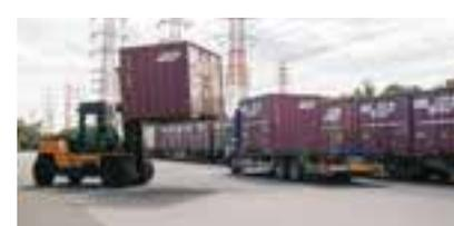
積み込みが終わると、駅員が2人1組となってコンテナの両側から1つ1つ確認していきます。コンテナの番号、固定状態、ドアの閉まり、封印など、たくさんチェック項目を指差し確認。キビキビした動作で、作業が進められていました。
