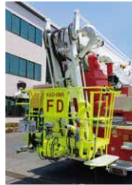
黄色いバスケットに人を乗せ、高所で作業できる
