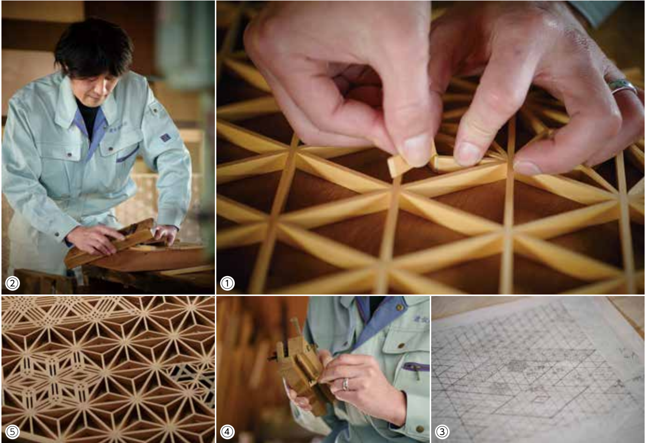
①手作業で地組にパーツを一つ一つはめ込む ②カンナでパーツに微妙な角度を付ける ③方眼紙に文様をデザイン。寸法の計算も書き込まれている ④特殊なカンナで溝を掘る ⑤美しい文様の世界が生まれる
