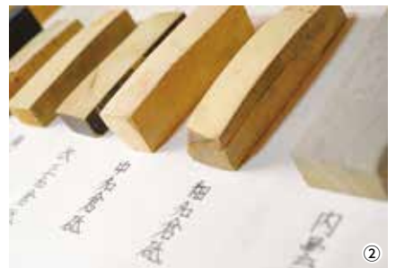
①下地研ぎは目の粗い砥石から細かい砥石に変えながら研いでいく ②8種類の砥石を使い分ける ③工程に合わせて砥石の形も変える ④使い込まれた研ぎの道具 ⑤仕上げ研ぎは繊細な作業が続く ⑥砥石を砕いた粒子で刃をこする
